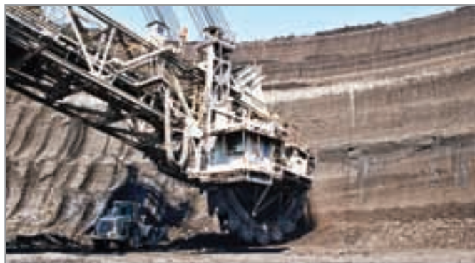
Καδοφόρος εκσκαφέας στο ΑΚΑΜ
