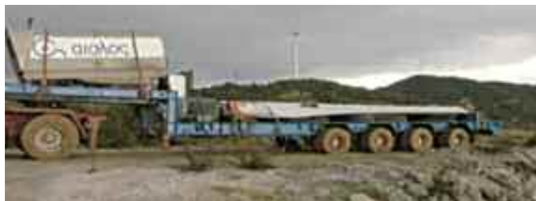
Τα αποξηλωμένα τμήματα μιας Α/Γ: άτρακτος, γεννήτρια, πτερύγια, απομακρύνονται από το αιολικό πάρκο και την Σάμο.
